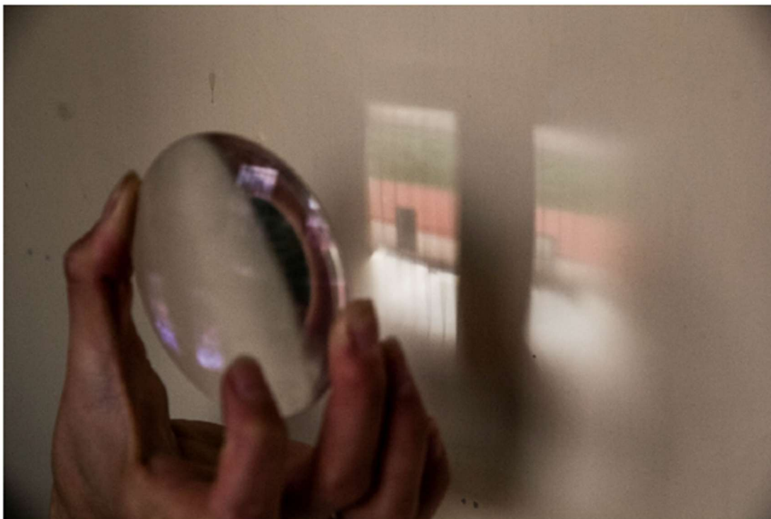
Obr. 22: Zobrazení okna spojkou.
