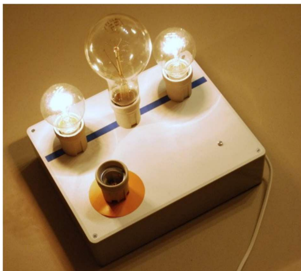
Obr. 6: Vaškova krabice se sériovými žárovkami – vše dokonale popsáno v [2]
