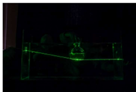
Obr. 24: Chod paprsků baňkou vyplněnou olejem.
