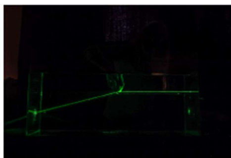
Obr. 18: Chod paprsků rozptylkou.
