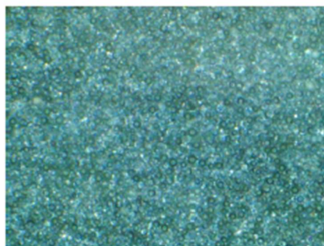
Obr. 10: Odrážný pruh na vestě pod mikroskopem.
